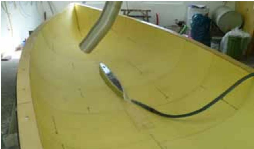
*Mit Vakuum eingeklebte Sandwichplatten*
