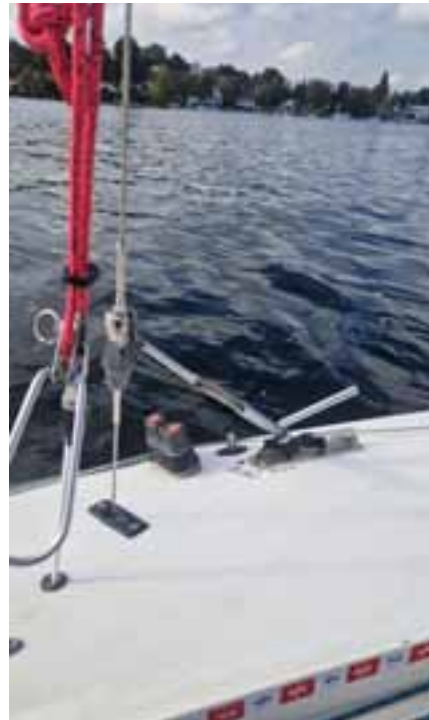
Wantenbruch: der Spanner.
